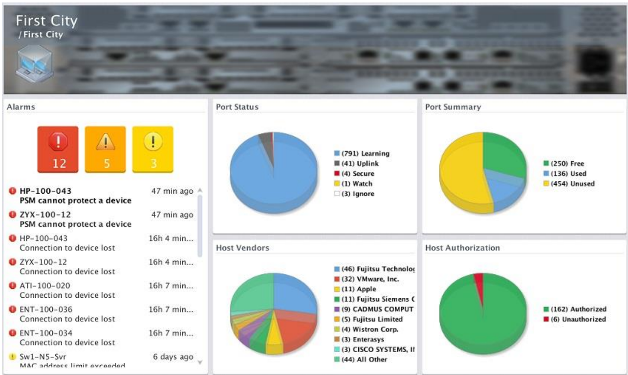
Abb. 1 Grafisches Dashboard mit granularen Alarm-Updates und aktuellen Zusammenfassungen des Port-Status
